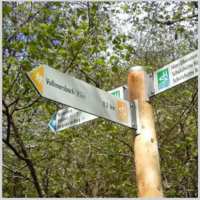
Rozcestník do přírodních rekreačních ploch - dřevěný sloupek a šipky z hliníkového plechu.
