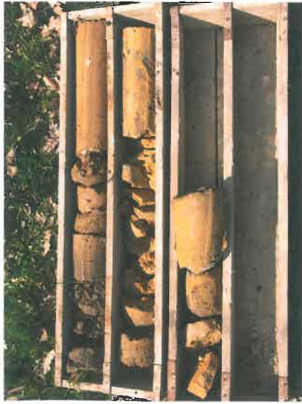
Foto č. 7: Výnos poloporušených a porušených vzorků zemín z průzkumné geologické sondy GS-5.
