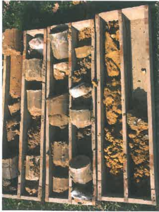
Foto č. 3: Výnos poloporušených a porušených vzorků zemin z průzkumné geologické sondy GS-1.
