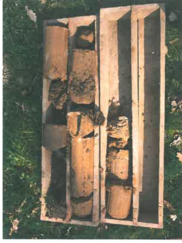
Foto č. 6: Výnos poloporušených a porušených vzorků zemín z průzkumné geologické sondy GS-4.
