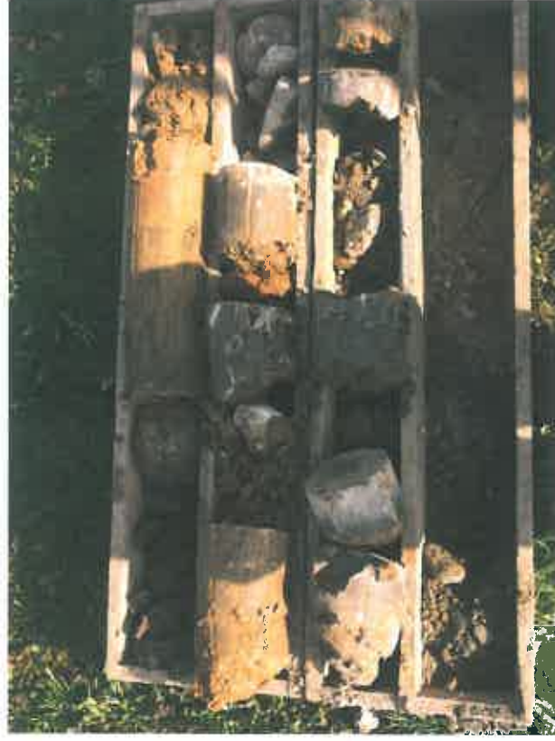
Foto č. 4: Výnos poloporušených a porušených vzorků zemin z průzkumné geologické sondy GS-2.
