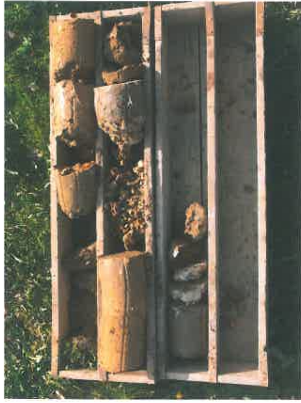
Foto č. 4: Výnos poloporušených a porušených vzorků zemín z průzkumné geologické sondy GS-3.
