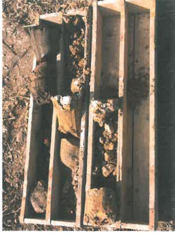
Foto č. 8: Výnos poloporušených a porušených vzorků zemín z průzkumné geologické sondy GS-6.
